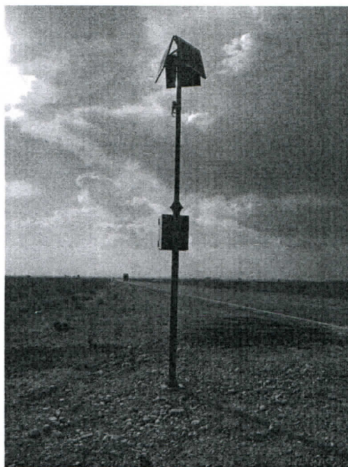
2 а сурет – Жоғарғы жағында күн панельдері орнатылған сигнал беретін антеннамен жабдықталған өлшеу кешендерінің жер үстіндегі бөлігінің түрі
